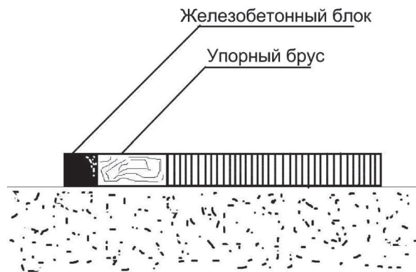
Рисунок 9.2 – Установка бруса по окончании работ
